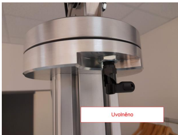
Ukázka potočení C-tracku doprava o 90° (lze i doleva).
