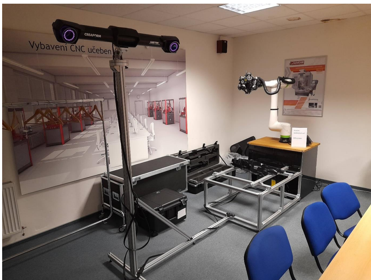
Ukázka potočení C-tracku doprava o 90° (lze i doleva).
